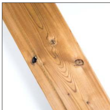
Malé otvory po vypadlých sucích jsou povoleny
