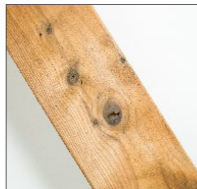
Praskliny v sucích jsou povoleny
