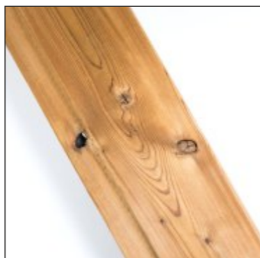
Malé otvory po vypadlých sucích jsou povoleny
