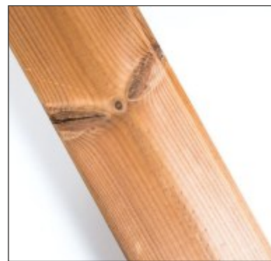
Praskliny v sucích jsou povoleny
