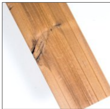
Praskliny kolem suků jsou povoleny
