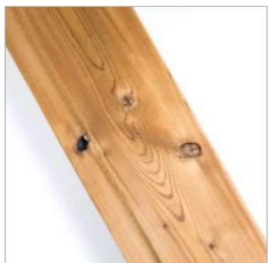
Malé otvory po vypadlých sucích jsou povoleny
