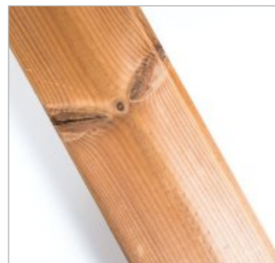
Praskliny v sucích jsou povoleny
