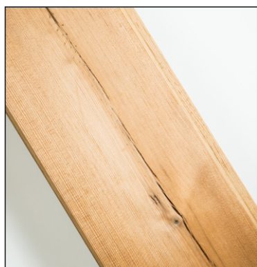
Malé praskliny na povrchu prken jsou povoleny
