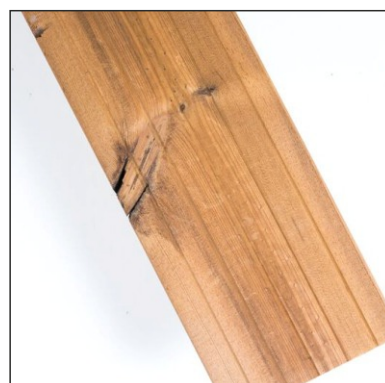
Praskliny kolem suků jsou povoleny
