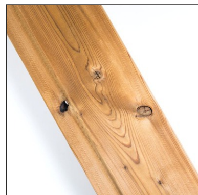
Malé otvory po vypadlých sucích jsou povoleny
