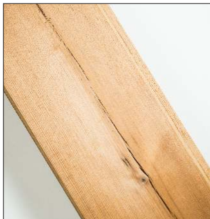
Malé praskliny na povrchu prken jsou povoleny
