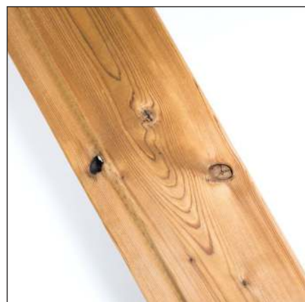
Malé otvory po vypadlých sucích jsou povoleny
