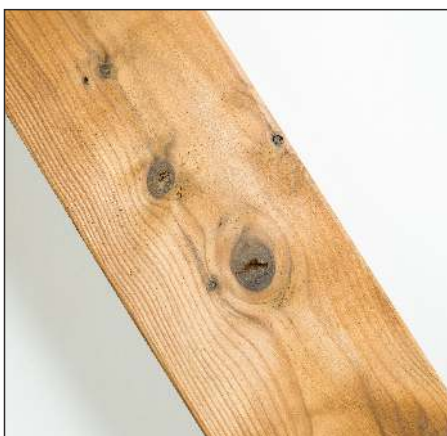
Praskliny v sucích jsou povoleny
